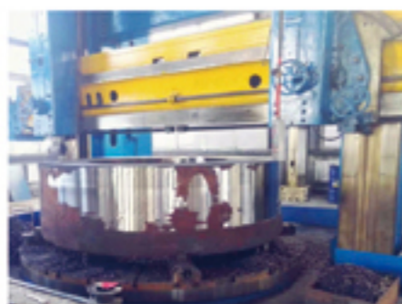
5m双柱立车 5m CNC Vertical Lathe
