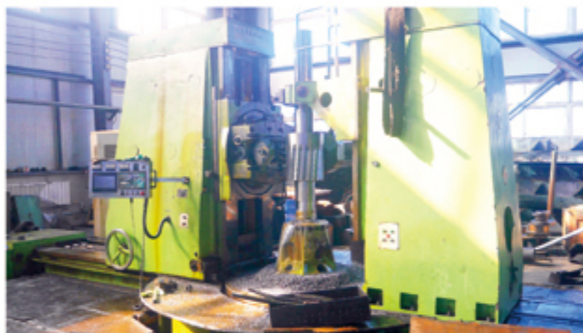
齿轮轴滚齿机 Gear Shaft Hobbing Machine
