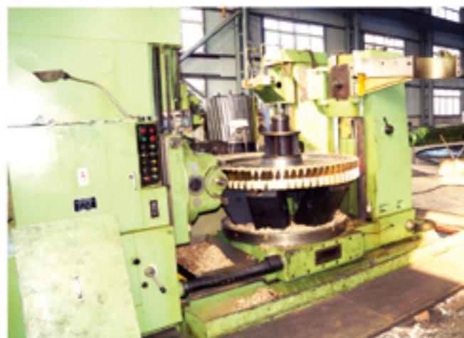
小型滚齿机群 Small Gear Hobbing Machines Group
