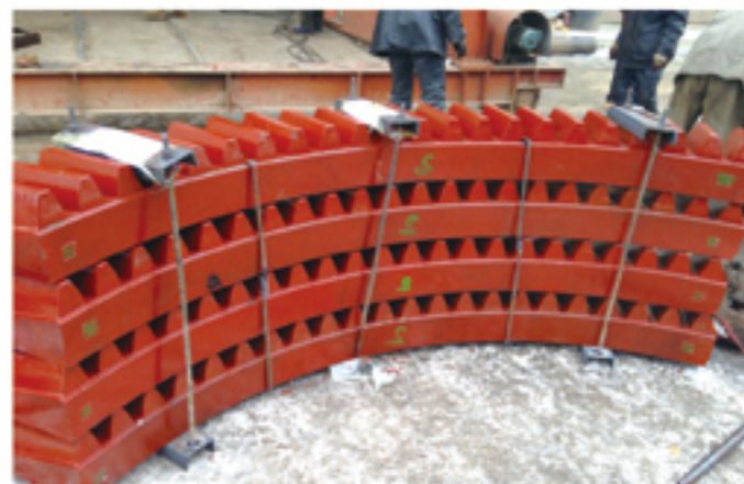
四分伞齿/ Bevel Gear M=36 Φ=8m
