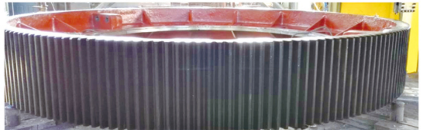
齿圈/ Girth Gear M=25 \Phi=8.3m
